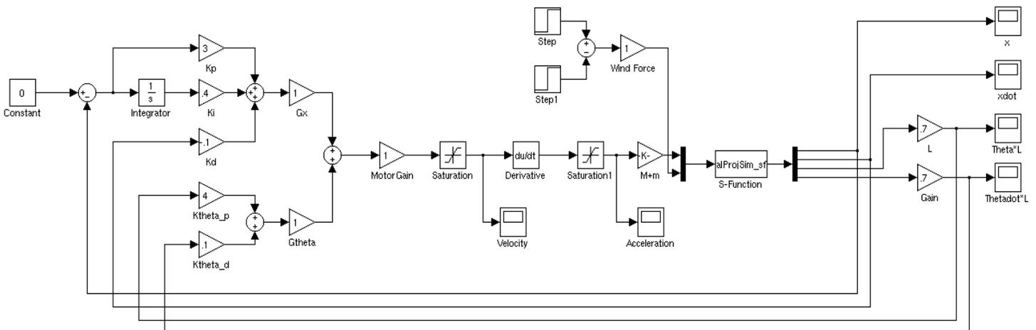
FIGURE 3. SIMULINK MODEL OF PENDULUM SYSTEM
